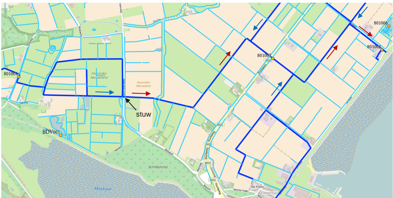
Figuur 3. Watersysteem Prins Hendrikpolder, met primaire (donkerblauw) en secundaire watergangen (lichtblauw). De locaties van de stuw bij meetpunt OW15 en de meetpunten 801004, 801007 en 801001 van HHNK zijn weergegeven. De primaire watergangen voeren water af in oostelijke richting, naar het gemaal bij meetpunt 801001. De afvoerrichting is met pijlen weergegeven (rood = afvoer ammoniumrijk water via hoofdwatergang; blauw is overige afvoer vanuit zijwateren).
